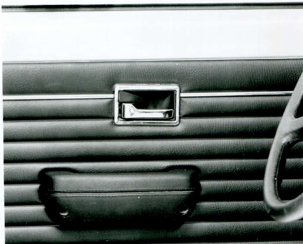
Opel Kadett, Türschloß-Innenbetätigung versenkt
