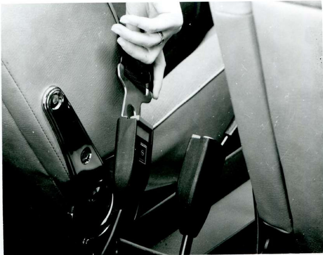
Dreipunkt-Sicherheitsgurte vorn, Einhandbedienung, alle Opel-Modelle
